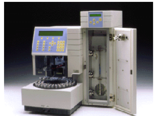
Exakte Temperierung der Säule und der Ventile
