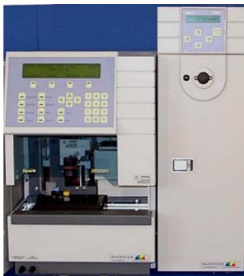
Der Probengeber Endurance micro und die Trennung von Cytochrom C – Verdau auf einer monolytischen Nanosäule 0,1 x 150 mm
